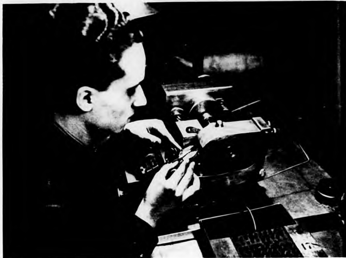
Una delle fasi più delicate: il taglio del pennino dopo l'applicazione di un grano di osmiridio sulla sua punta
